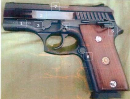
Espécie: Pistola Semiautomática. Marca: Forjas Taurus. Calibre: .380 ACP. Modelo: PT 938. Ações Simples e Dupla. Lado Esquerdo. Desengatilhada. Alimentada com Carregador para 15 cartuchos .380 ACP. Nomenclatura: 1 = Armação. 2 = Ferrolho. 3 = Alavanca de desmontagem. 4 = Retém do ferrolho. 5 = Registro de segurança e desarmador do câno. 6 = Retém do carregador. 7 = Câmara e Cano.
