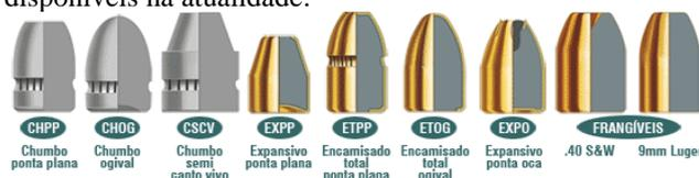
**Projétil encamisado** = São projéteis construídos por um núcleo recoberto por uma capa externa chamada camisa ou jaqueta. A camisa é normalmente fabricada com ligas metálicas como: cobre e níquel; cobre, níquel e zinco; cobre e zinco; cobre, zinco e estanho ou aço. O núcleo é constituído geralmente de chumbo praticamente puro, conferindo o peso necessário para um bom desempenho balístico. Vide figura.
